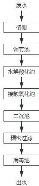
图 4-1 地埋式污水处理设施处理工艺
